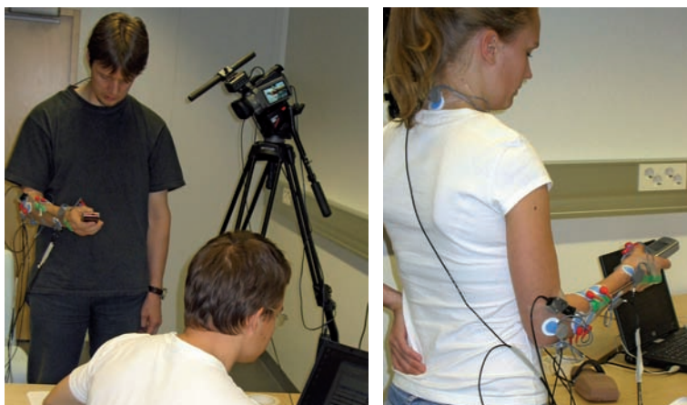
Kuvat 1 ja 2. Fysiologiset mittaukset. Testiproseduurilla pyrittiin mallintamaan tekstiviestin kirjoitusta koehenkilön seisossa käden ollessa kullekin koehenkilölle ominaisessa asennossa. Testisuoritus tallennettiin kahdella digitaalivideolla. Järjestelmä synkronoi videodatan automaattisesti EMG- ja nivelkulmasignaalien kanssa.
